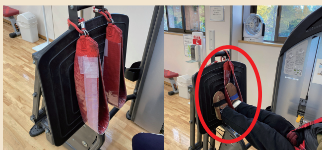
脱力による脚の落下を防ぐため、レッグプレスに取り外し式のサポーターを設置 〔東京都障害者総合スポーツセンター〕
